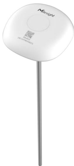
星纵物联 TS101 是一款坚固可靠的一体式探针温度传感器。产品拥有 40cm 长探针且顶部内置高性能测温元件，可精准测量烟垛/粮垛等内部温度，并通过无线 LoRaWAN<sup>®</sup> 传输到平台端，实现远程高效监控烟草或粮食的养护情况。除了使用 LoRa<sup>®</sup> 低功耗技术，产品内置 1 节 4000 毫安时锂亚电池，续航高达 10 年。
