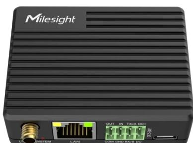
星纵物联 UR41 是一款小尺寸、低功耗、高性价比的 4G 工业路由器。紧凑轻量化设计，有效节省部署空间，可满足嵌入式小型化应用通信需求。同时具备优秀的电源管理能力，支持待机模式与空闲模式，确保设备超低功耗稳定运行。
